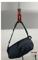
TEST DE RÉSISTANCE DE LA SANGLE
