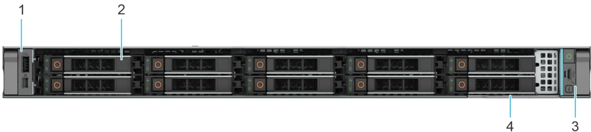
Figure 4. Vue avant du système à 10 disques de 2,5 pouces avec E/S à l'arrière
