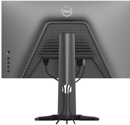
Nach Anschließen aller erforderlichen Kabel an Ihrem Monitor und Computer (siehe **Ihren Monitor anschließen** zum Anschließen der Kabel) organisieren Sie sämtliche Kabel wie oben abgebildet.
