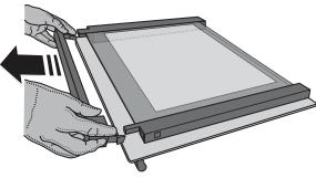
**2.** Sollevare e prendere saldamente il vetro interno con due mani, rimuoverlo e appoggiarlo su un piano morbido prima di eseguire la pulizia.
