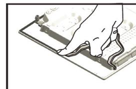
Per bloccare il piano di cottura, utilizzare le staffe (A) in dotazione. Posizionare le staffe in corrispondenza dei fori evidenziati dalla freccia e fissarle con le apposite viti in modo da adattarle allo spessore del top (vedere le figure seguenti).
