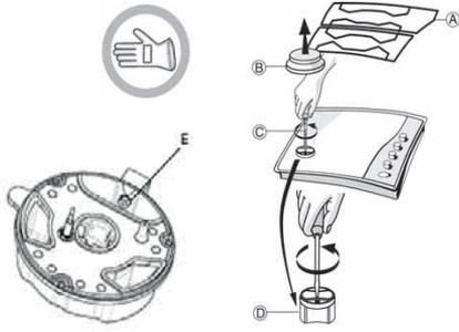
Prima di installare il piano di cottura, ricordarsi di applicare la targhetta di taratura gas fornita con gli iniettori di ricambio, in modo che copra le informazioni già presenti.
