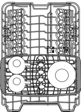
Il cestello superiore è munito di piano scorrevole adatto ad alloggiare stoviglie di piccole dimensioni e posate. Per ottimizzare le prestazioni di lavaggio, evitare di sistemare posate di dimensioni ingombranti direttamente in corrispondenza del punto sottostante al piano scorrevole. Il piano scorrevole è rimovibile.
