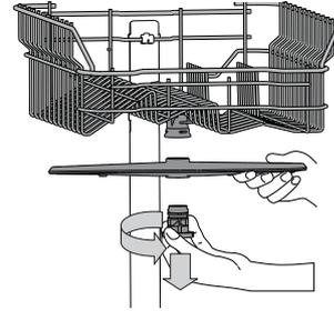
Per smontare il braccio aspersore superiore, ruotare l'anello di bloccaggio in plastica in senso antiorario. Il rimontaggio del braccio aspersore deve avvenire in modo che il lato con il maggior numero di fori sia rivolto verso l'alto.
