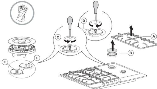
Prima di installare il piano di cottura, ricordarsi di applicare la targhetta di taratura gas fornita con gli iniettori di ricambio, in modo che copra le informazioni già presenti.
