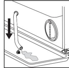
3. Ruotare la manopola del filtro di scarico ed estrarlo dall'alloggiamento.
