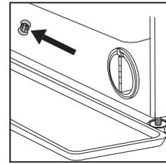
Togliere il tappo del "tubo di scarico di emergenza" all'estremità del tubo e lasciar defluire l'acqua nel contenitore.
