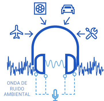
Micrófono para la cancelación de ruido (NC) Situados dentro y fuera de las copas auriculares
