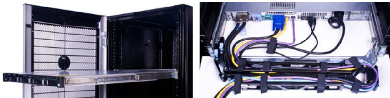
Figure 14. Système monté sur rails coulissants avec le bras CMA
